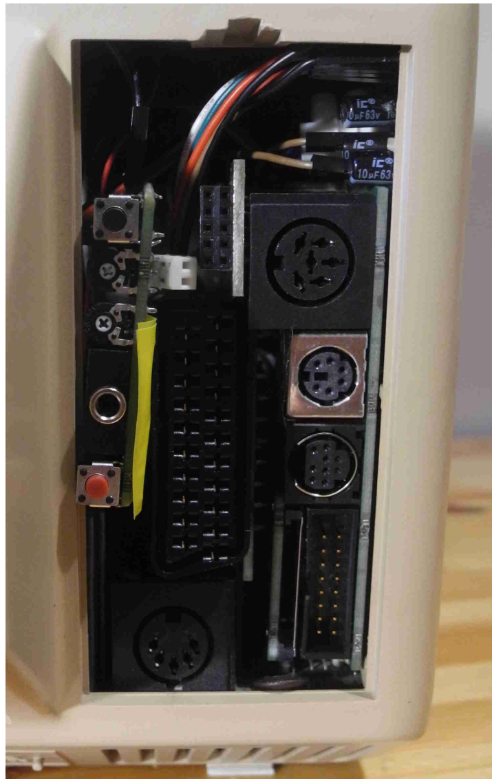
Photographie des connecteurs à l'arrière du Minitel modifié
